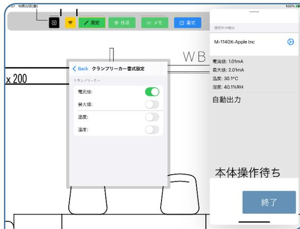
測定値が反映されると測定ポイントにはすべての測定項目が保存され、書式設定で選択した項目の測定値のみが表示されます。測定値を反映後、測定ポイントを選択した状態でクランプリーカー書式設定を表示し、書式設定の項目を変更すると測定ポイントの表示項目が変わります。
