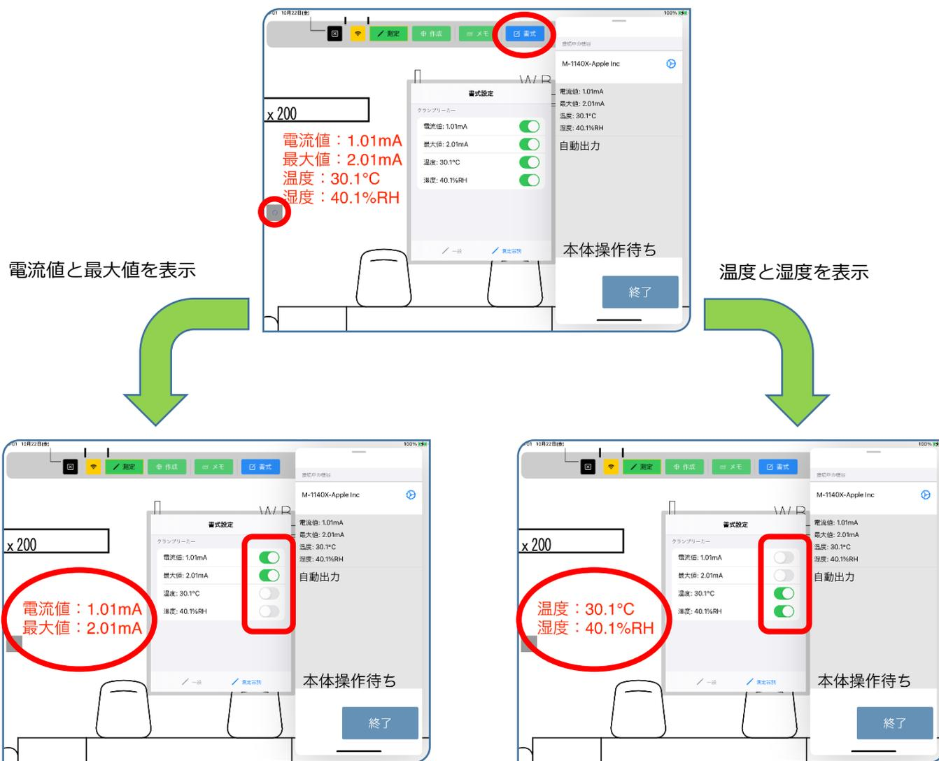
測定ポイントは複数選択することができ、複数の測定ポイントを選択した状態で表示項目を変更した場合、選択したすべての測定ポイントの表示項目が変更されます。測定ポイントを選択せずに表示項目を変更した場合、今後新たに作成する測定ポイントの表示項目が変更されます。
