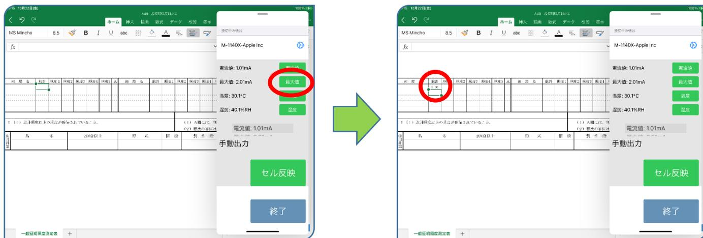
セル反映ボタンをタップすると、測定項目リストで選択した項目の測定値が選択しているセルに反映されます。
