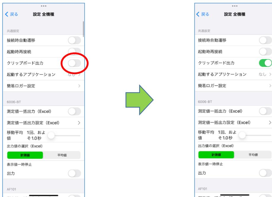
クリップボード出力機能が有効の場合、測定画面には「測定値コピー」ボタンが表示されます。
