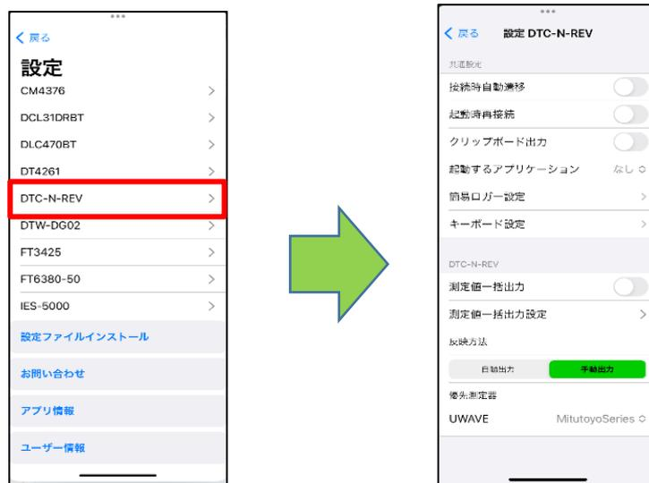
③ 優先測定器のプルダウンを選択し、「DTC-N-REV」を押下する。
