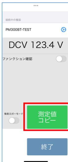
連携中の上位アプリにかかわらず、「測定値コピー」ボタンを押下するとクリップボードへ値を出力します。その他、自動出力などの出力操作によってもクリップボードへ値を出力します。
