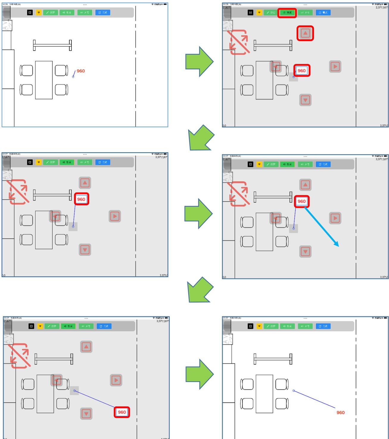
測定値の移動モードになると、左上に拡大縮小禁止マークが表示され、PDF 図面の拡大縮小・移動ができない状態になります。
