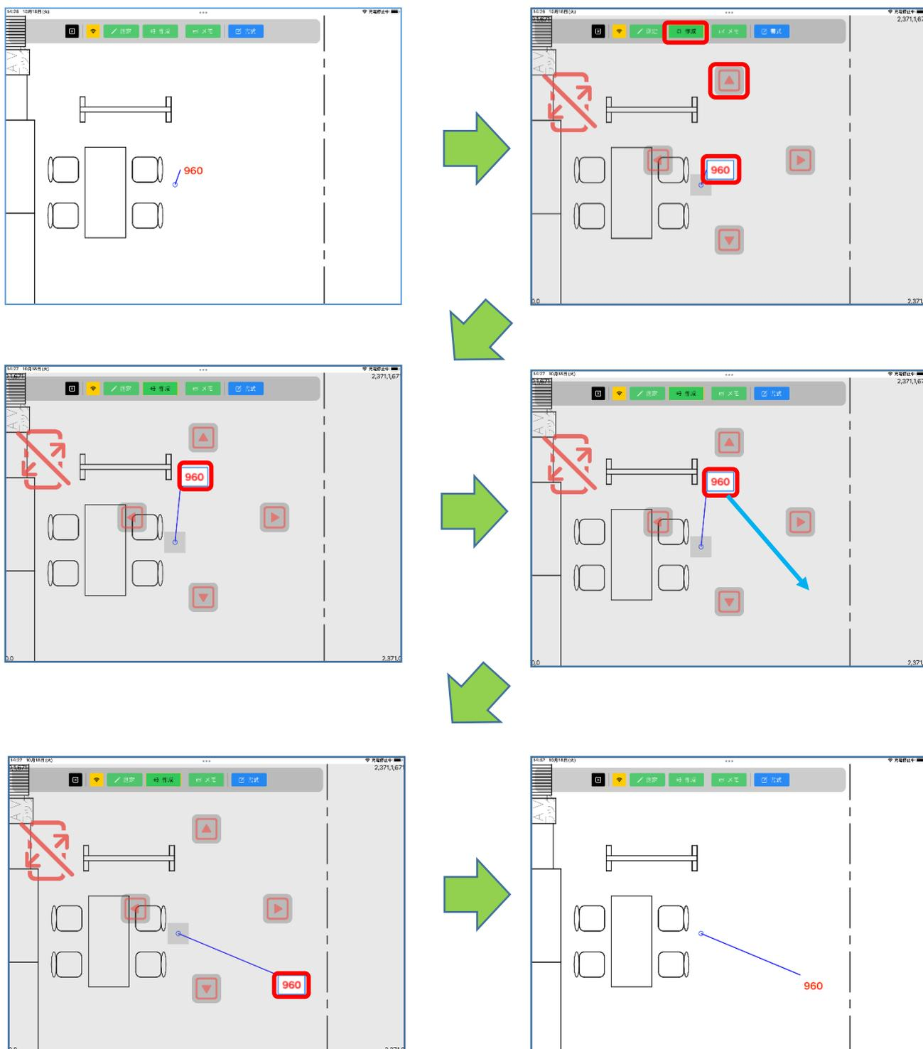
測定値の移動モードになると、左上に拡大縮小禁止マークが表示され、PDF 図面の拡大縮小・移動ができない状態になります。
