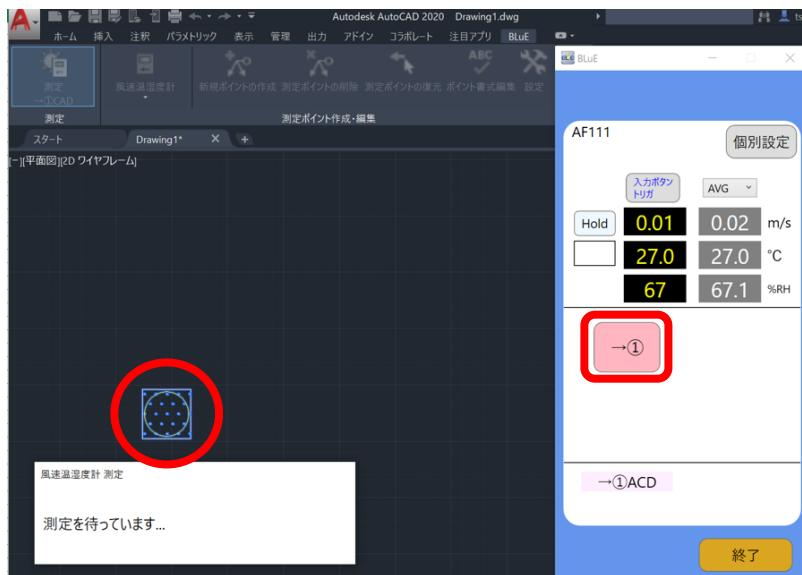
(4) 測定画面の測定ボタン (→①) を押下すると、ピックした測定ポイントに対して測定値が反映されます。
