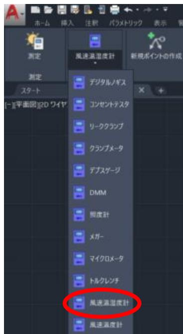
(2) リボンメニューの「新規ポイントの作成」を押下し、図面上の任意の箇所をピックすると測定ポイントが作成されます。
