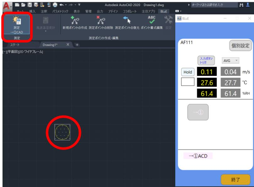
(3) 網掛けされた測定ポイントをピックすると、網掛けが青色に変化しかつ、測定画面の測定ボタン（→①）がピンクに変わり、測定できる状態となります。
