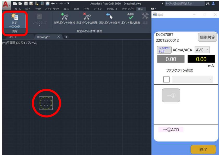
(3) 網掛けされた測定ポイントをピックすると、網掛けが青色に変化しかつ、測定画面の測定ボタン（→①）がピンクに変わり、測定できる状態となります。
