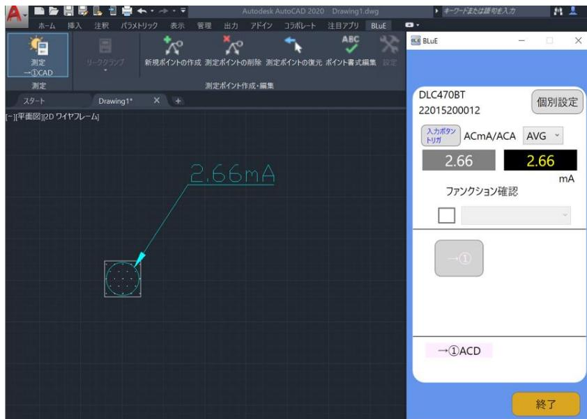
※測定画面(BLuE)で接続している測定器と AutoCAD 上の測定ポイント種別が、同じでないと測定値を反映することができません。
