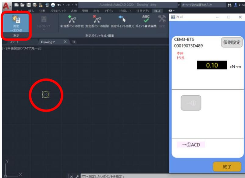
(3) 網掛けされた測定ポイントをピックすると、網掛けが青色に変化しかつ、本体のメモリキー（オレンジ）を押すと測定値が反映されます。
