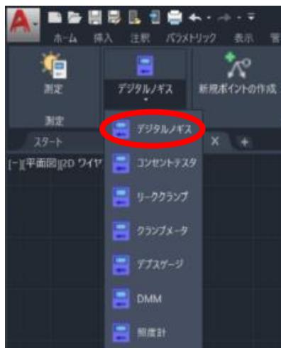
(2) リボンメニューの「新規ポイントの作成」を押下し、図面上の任意の箇所をピックすると測定ポイントが作成されます。
