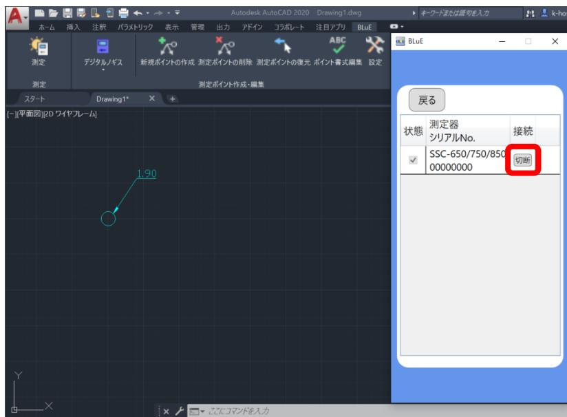
(4) 接続状態チェックボックスにチェックが入っていなければ切断完了です。
