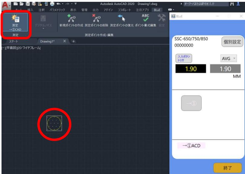
(3) 網掛けされた測定ポイントをピックすると、網掛けが青色に変化しつつ、測定画面の測定ボタン（→①）がピンクに変わり、測定できる状態となります。
